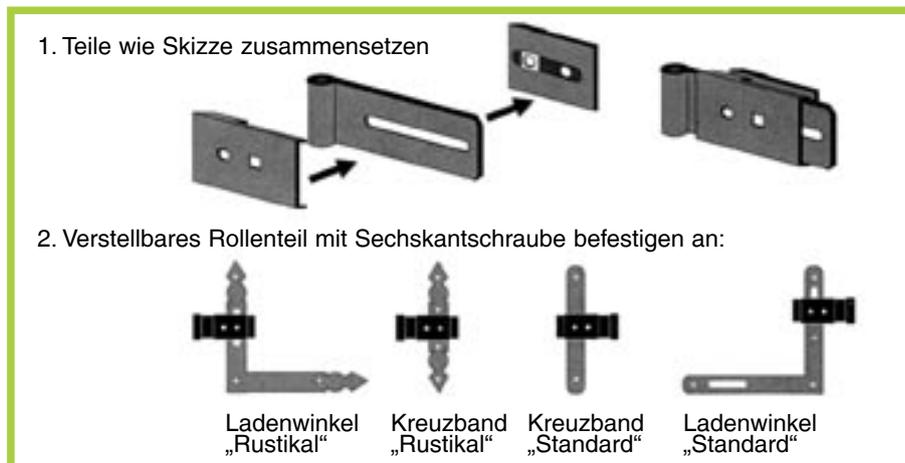
Bei Sanierungsmaßnahmen, Altbaurenovierung und Fenstermontage im unverputzten Rohbau müssen Beschläge die Möglichkeit aufweisen, auftretende Unebenheiten auszugleichen. Für diesen Zweck bietet PFEIFER die Systeme „Standard“ und „Rustikal“ in einer verstellbaren Version an. Die hohe Stabilität von Band und Kloben bleibt auch bei voller Nutzung des Verstellbereiches erhalten.
